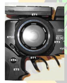
ET1 rechts: Geradeaus Lauf nach rechts korrigieren ET1 links: Geradeaus Lauf nach links korrigieren
