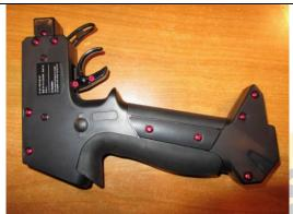
Alu Schrauben Blau Ko Propo Artikel-NR.: KO10533, Alu Schrauben Rot Ko Propo Artikel-Nr.: KO10534 und Alu Schrauben silber Ko Propo Artikel-Nr.: KO10535. Eingentlich sind diese Schraubensets für den Ko Propo K.I.Y. EX-1 Pistolensender. Doch man kann alle Schrauben die für den Griff vorgesehen sind auch für den Griff der Syncro EX-6 verwenden. Leider können für die Sendeeinheit nur 2 Schrauben des Sets genutzt werden. Der Rest bleibt über.
