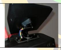
Die Firma Atomic hat einen Dreh – und Schwenkfuß für den starren Monitor der Kyosho Syncro Ex-6 herausgebracht (Atomic Artikel Nr. AW-012). Mit diesem Dreh- und Schwenkfuß kann man nun den Blickwinkel seitlich und in der Höhe verstellen um den Kontrast auf den Bildschirm zu verbessern und einen optimalen Blickwinkel ein zu stellen.
