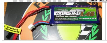
Der LiFePo4 Akku von Hobbyking mit einer Kapazität von 1450mAh und 6.6Volt passt ideal in die Ko Propo optionale Akkuhalterung Ko Propo Artikel-Nr.: 10546. Wichtig man muss dann den Akkutyp in den Einstellungen des Pistolensenders ändern (siehe am Anfang der Anleitung).
