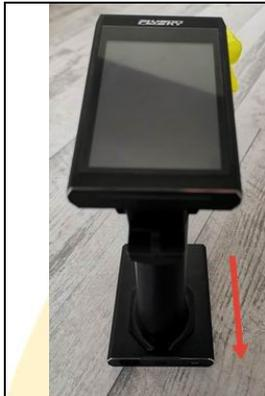
Die Powerbank muss in den Griff eingesetzt werden, in dem man Sie von Vorne Ansetzt und an sich heran zieht zum Einrasten.
