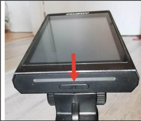
Nun den Pistolensender ausschalten indem Sie die lange breite Taste an der vorderen Außenfläche des Displays für 2 Sekunden drücken.
