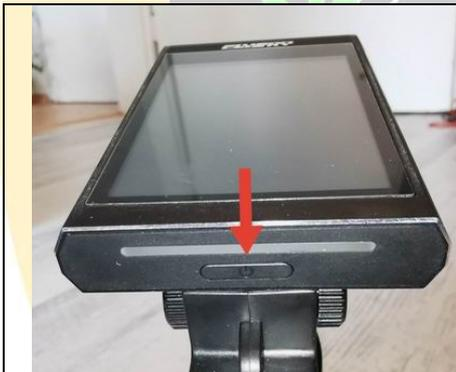
Nun den Pistolensender einschalten indem Sie die lange breite Taste an der vorderen Außenfläche des Displays für 3 Sekunden drücken.
