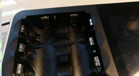
Das Foto zeigt das hintere Ladeschacht noch für AA Zellen wie vom Hersteller ist, der vordere aber abgeändert für die Aufnahme von AAA Zellen. Wichtig, setzt man in einem auf AAA abgeänderten Schacht einmal eine AA Zelle ein, so muss man die Kontakte wieder nachbiegen. Das führt auf die Dauer zur Ermüdung der Kontakte.
