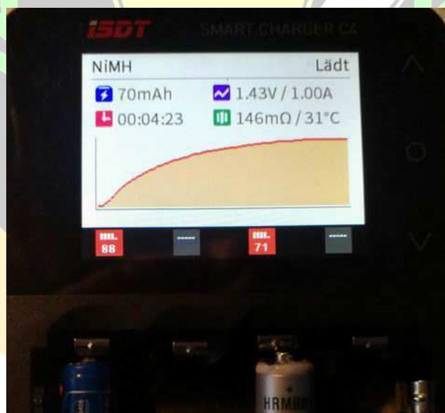
Auf dem Bildschirm wird während des Vorgangs angezeigt in der obersten Zeile, welcher AkkuTyp gerade Lädt, mit welchem Vorgang (lädt) oben rechts in der Ecke. In der Untersten Zeile wird angezeigt von welcher Ladeschale die derzeit angezeigten Werte sind. **Rote** Quadrate mit dem & Wert zeigen an, das der Vorgang noch läuft. Ist das Quadrat **Grün**, ist der Vorgang schon beendet.
