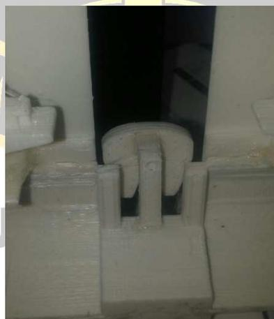
Jetzt solltest du nur noch die beiden Tanks und die Verstärkung vor dir liegen haben. Die Verstärkung kommt **auf** die Radkästen. Hierzu müssen die beiden Verstärkungen erst einmal in der Länge angepasst werden. Einfach mit dem Seitenschneider einkürzen. Und anschließend mit ein paar
