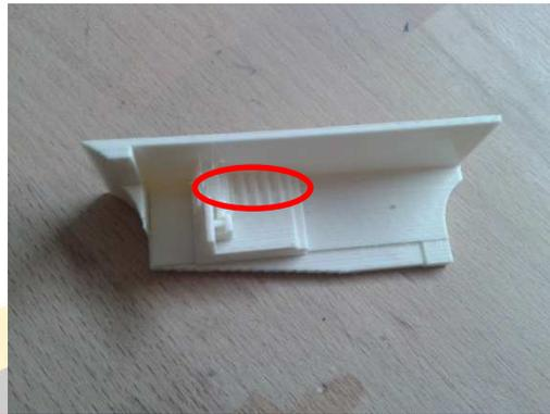
Nachdem nun alle Stützstrukturen entfernt wurden, müssen wir noch die Klebestellen ein wenig mit dem Schleifpapier bearbeiten.
