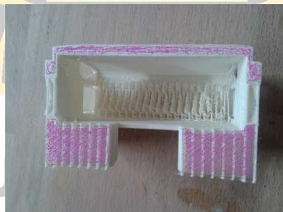
Anschließend die Fenster vorsichtig mit dem Skalpell raus schneiden. Die größeren Flächen lassen sich leicht mit dem Finger eindrücken und die Feinarbeiten mit dem Skalpell. Achtung nicht die
