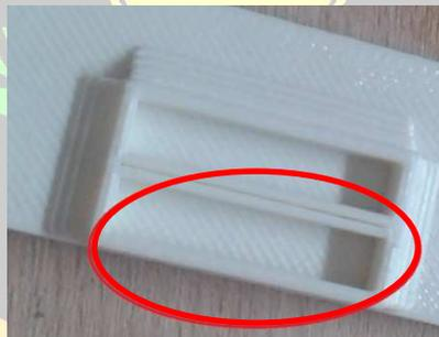
Nachdem dies erledigt ist, sollte mit dem Schleifpapier, die Obere Kante ein wenig glatt schleifen, damit der Kleber besser hält. Dazu das Schleifpapier auf einen ebenen Untergrund (Tisch)legen und die Front mit der markierten Seite auf dem Schleifpapier hin und her bewegen.
