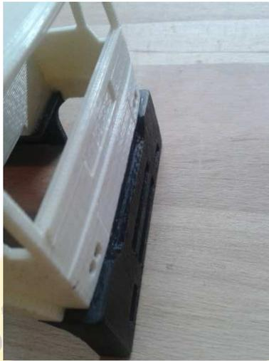
Im nächsten Schritt kommt die Sattelplatte dran. Diese zuerst mit dem Halter verbinden und zwar mit Sekundenkleber.
