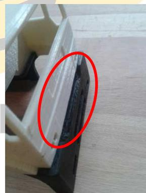
Anschließend können wir die Seitenteile ans Führerhaus kleben. Hierzu die Fläche an den Seitenteilen mit Sekundenkleber benetzen und an das Führerhaus drücken, zur Hilfe kann man jetzt eine Klemme oder Wäscheklammer nehmen.
